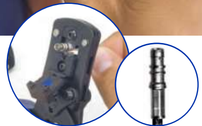
Crimpen von FAKRA-Steckern an abgeschirmten Leitungen Crimping of FAKRA connectors on shielded cables Sertissage de FAKRA connecteurs aux câbles écrantés
